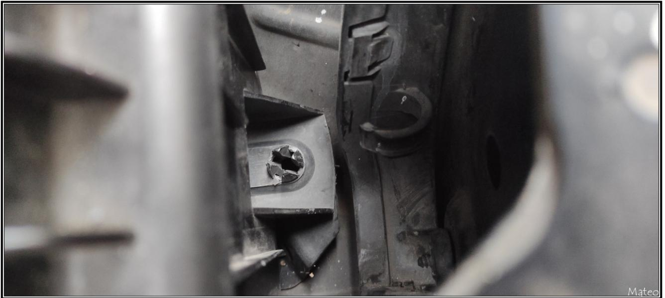
Ma technique pour éviter de les abimer, et de presser avec une douille de 9mm pour rétracter chaque pin et de soulever la boîte.
