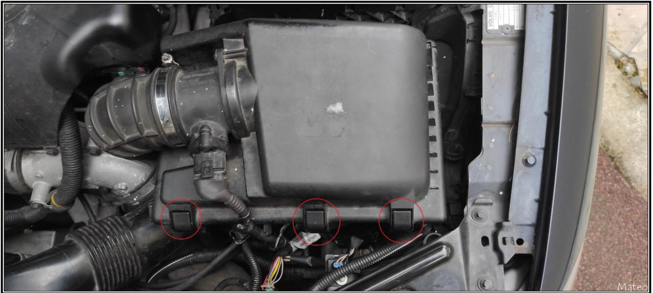
Débrancher la prise du débitmètre et dévisser le collier de la durite d'admission pour avoir plus d'aisance pour sortir le capot de la boîte à air.
